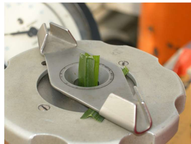
Tlaková scholandelova komora Meranie vodného potenciálu
