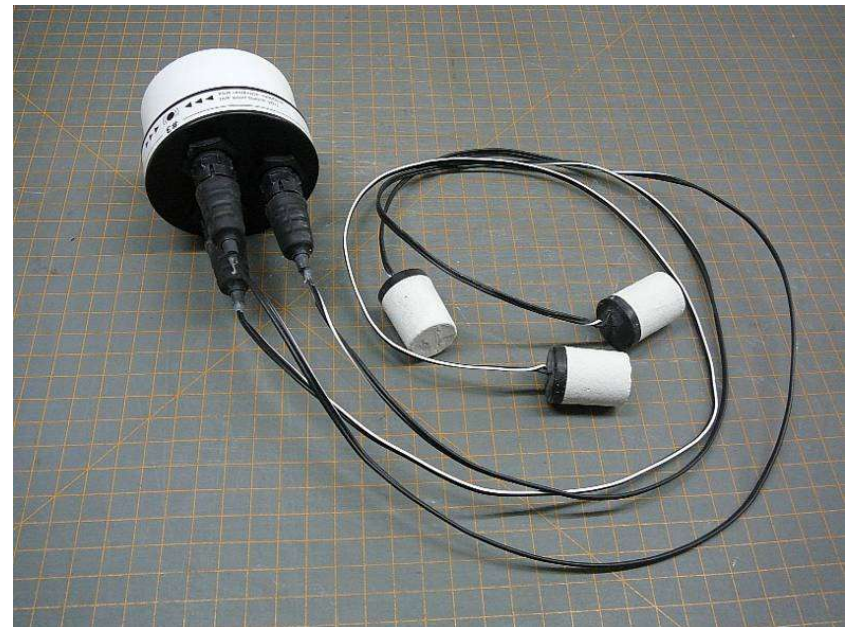
Meranie objemovej vlhkosti pôdy a vodného (sacieho) potenciálu pôdy
