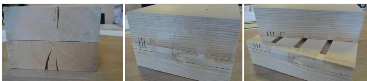
Obrázek 1 Dokumentace modelů ze smrkového dřeva pro exponování mikrovlnným zářením
