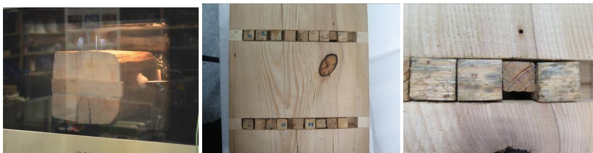
Obrázek 4 Dokumentace ohřevu modelů horkým vzduchem a detail tělísek po ohřevu
