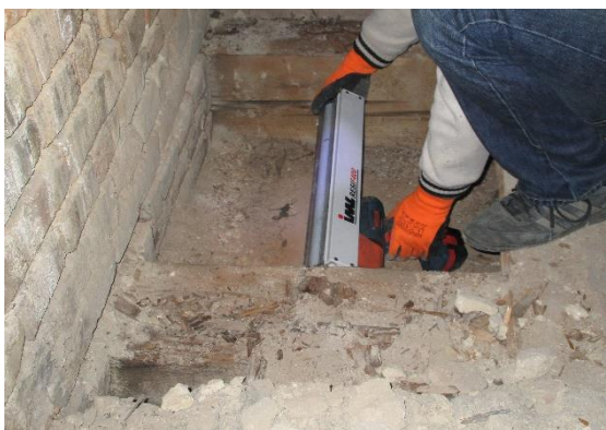
Obrázok 4 Krov a stropy v Dome hudby v Bratislave – Vrtý Resistographom z boku prvkov
