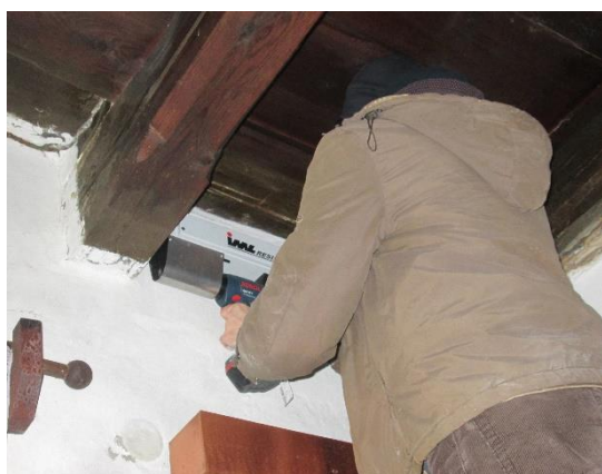
Obrázok 2 Stropy v kúrii múzea K. Plicku v Blatnici – Vrtý Resistographom z boku trámov pri záhlaviach
