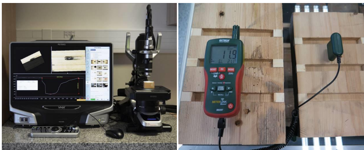
Obrázek 3 Ukázka měření mikroskopické struktury dřeva na digitálním mikroskopu Keyence VHX5000 a měření vlhkosti dielektrickým vlhkoměrem Meterlink M0297
