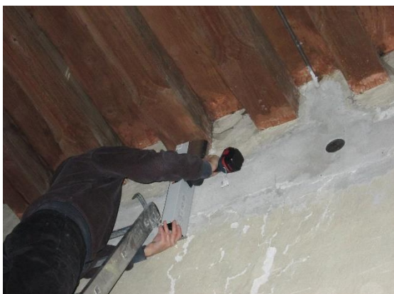
Obrázok 3 Strop v Rytierskej sále Radvanského kaštieľa v Banskej Bystrici – Vrtý Resistographom od spodku trámov pri záhlaviach
